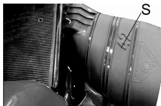
Fig. 8 – Protección del deflector
